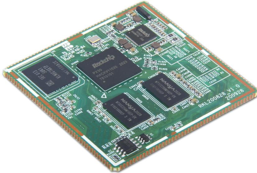
金亚太的 Rockchip PX30 核心板，采用 PX30 工业级 64 位低功耗处理器,主频高达 1.3Hz,拥有四核 Cortex-A35,双核 Mali-G31GPU,以及丰富的显示扩展接口,可搭配多种显示屏,更好地满足市场不同环境下的显示需求,适应于物联网设备、智能教育、车载中控、游戏设备、商显一体设备、医疗健康设备、自动售货机、工业电脑等行业。
