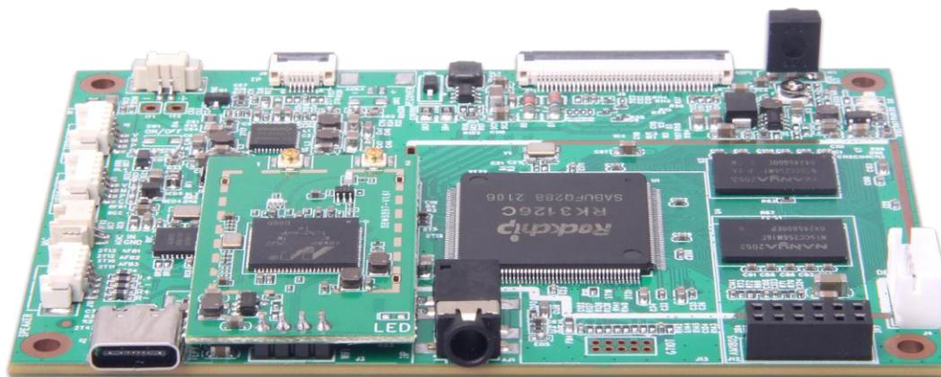
金亚太 DB3126 开发板采用 Cortex-A7,频率高达 1.2GHz 的高性能四核处理器，内置 Mali400 MP2 GPU，支持流畅的高分辨显示和主流游戏，可支持 Android/Linux 双操作系统，是一款兼具高性能和稳定性的主板，
