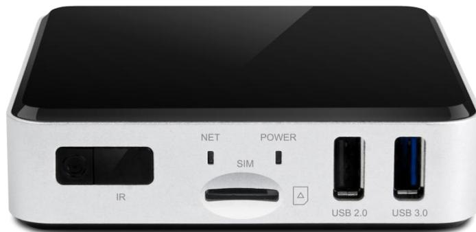
APC390K 是一款搭载 Rockchip 64 位高性能低功耗 RK3566 的工控盒子，具有强大视频硬解码能力和丰富的接口（支持 GTOIT、RS232、IR blaster...），并支持有线无线（WIFI、LTE）多种灵活通讯方式，可应用于 AIOT 物联网设备、商显、数字标牌、智能家居、视频会议，智慧医疗……
