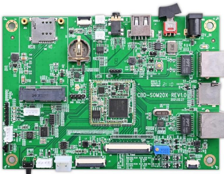
SSD20X 是 SigmaStar 公司的一颗高度集成的 SOC 芯片。它基于 arm Cortex-A7 双核 1.2GHz，集成了硬件 H.264/H.265 视频解码器、内置了 DDR，内置 2D 图形引擎、支持 TTL/mipi 屏显示驱动接口，内置了以太网 MAC 和 PHY 等，主要应用于智能楼宇室内机，智能家居中控，小型网关，电梯楼层显示器，智能网关，语音识别家电应用，VOIP，咖啡机等带屏幕显示的很多场景。
